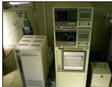
本市では、硫黄酸化物の一種である二酸化硫黄を、昭和46年度から自動測定機を用いて測定しています。近年の測定では、ほぼ横ばいで推移し、環境基準を満たしています。測定地点の見直しにより平成25年度に1地点の測定を廃止しました。
