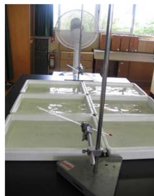
風下の方は、測定開始後1分で1.5°C下がるが、風上では1.0°Cしか下がらない。このことから、水面を通った風の温度は、通常の空気の温度より冷たいことが分かる。
