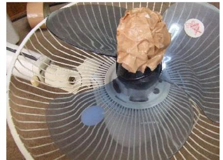
右写真のようにカバーをはずし、回転翼の中心にガムテープで卵を固定した。
