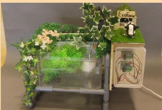
水槽の水を野菜栽培に活かす高循環型農園を考えました。金魚の糞をバクテリアが分解し、野菜の養分となり、金魚が元気になる溶酸素の多い水が排出されます。ファンとペルチェ素子で水を温調し、金魚の快適な温度にする事で金魚が元気になり、ハイドロボールにバクテリアの住みやすい環境を作る事で生態系の循環効率を上げます。
