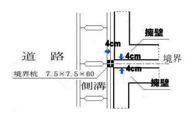
(12) 区画道路 9-1、9-2、1 2-1、1 2-2 号路線は車道と歩道の境界に歩車道ブロック、 又はガードパイプが設置してあります。敷地への車両の出入りは、工事の承認を得ること により、このブロックを開口し乗入口を設けることで可能となります。なお、開口部は標 準 4.2mとなります。交通安全上、設置が難しい位置もありますので、乗入口の設置を希 望される場合はご相談下さい。
