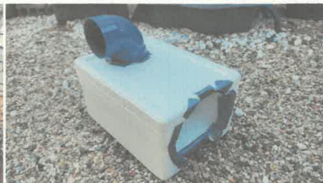
冷風機（発泡スチロールの中に氷を入れて風を送ると冷たい風が出てくる仕組み）
