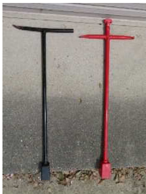
消火栓ハンドル
