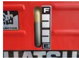
オイルメーター F側が満タン
