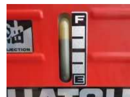
オイルメーター F側が満タン
