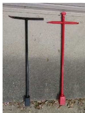
消火栓ハンドル
