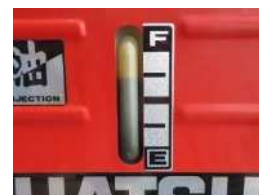
オイルメーター F側が満タン
