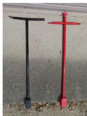
消火栓ハンドル
